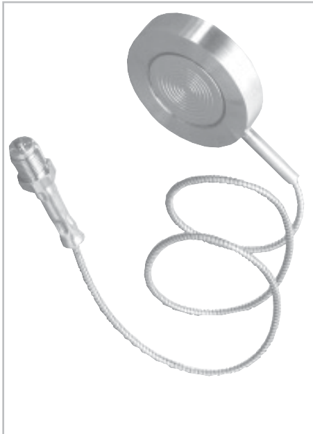
Séparateur "PANCAKE" DN25 tout inox, raccord instrument 1/2" femelle Gaz ou Npt.
