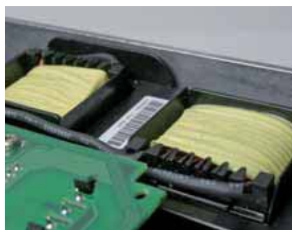
Les selfs DC réduisent les taux de distorsions harmoniques et protègent le variateur. Les filtres RFI (selon la norme EN55011 – A2, A1 ou B) sont inclus.
